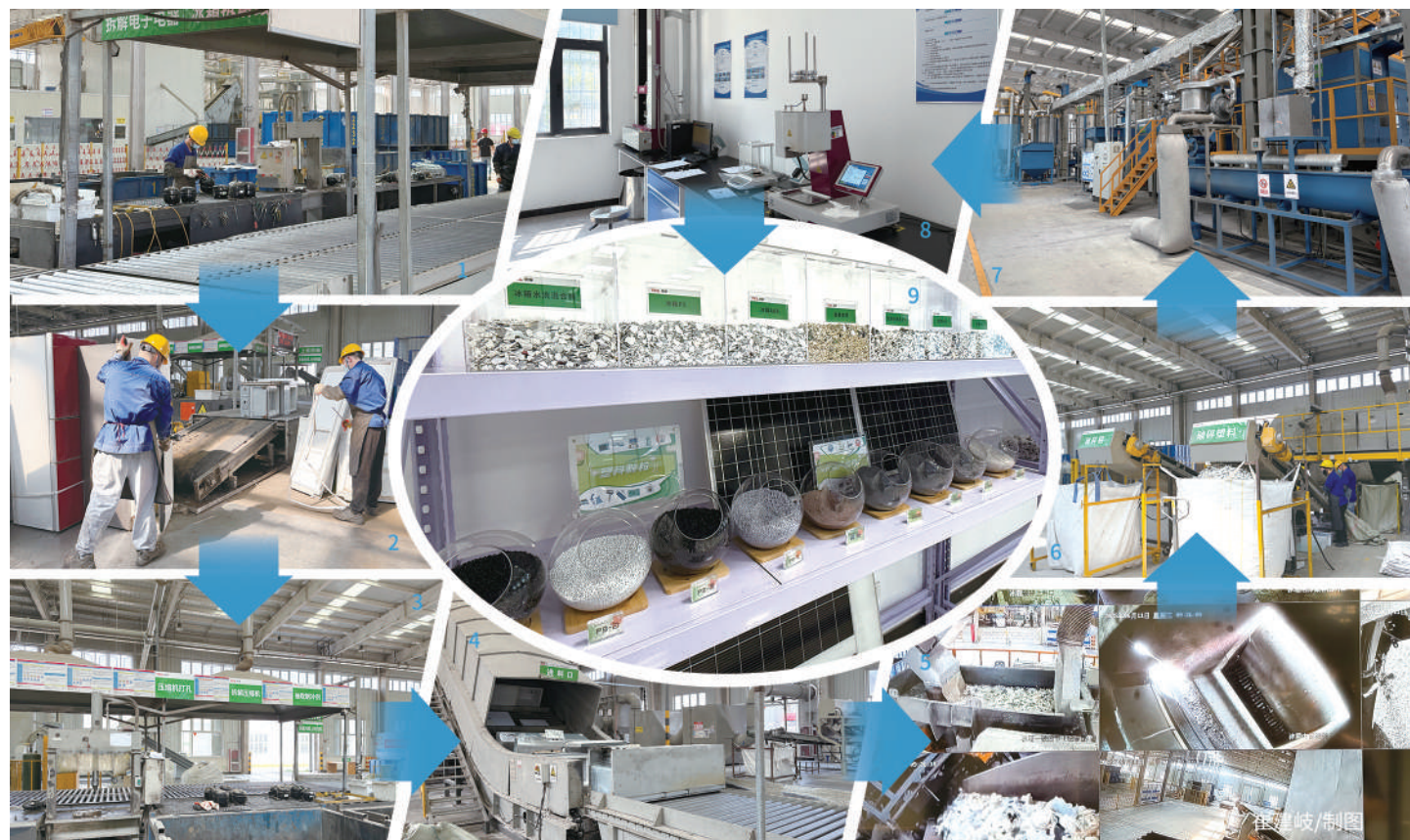
图①步骤一：智能分拣 图②步骤二：拆卸门体 图③步骤三：危险废物剔除（拆卸压缩机） 图④步骤四：冰箱箱体破碎 图⑤步骤五：各类材料分解 图⑥步骤六：初级原料分选 图⑦步骤七：相关原材料深加工 图⑧步骤八：合规检测 图⑨拆解最终成品 田鹏/摄
