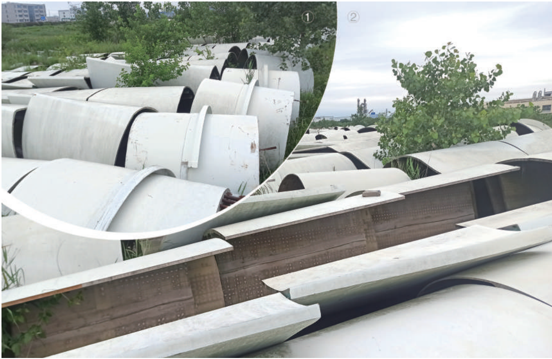
图①图②退役风电设备里拆除的叶片
