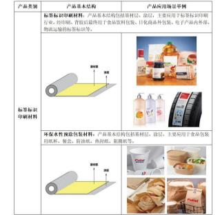
注:上表中图片仅展示公司产品的部分应用场景,图中具体使用的产品不全 电子级功能材料使用在消费电子、汽车电子中,以粘结、固定各元器件或模块,并起到防尘、保护、 导热、导电、隔热、绝缘、抗静电、标识等不同作用。产品胶粘层的高分子聚合物结构设计、功能性添加 剂的选择与使用、涂液配制工艺与配制环境控制、涂层微观结构设计与实现、精密涂布工艺等决定了 电子级功能材料的性质和功能,是电子级功能材料的核心技术。目前公司的电子级功能材料主要包 括胶带系列。保护膜系列和宽型膜系列。主要应用于消费由子领域。加兹里、华为、三星及国内知名高 端品牌手机、电脑、无线充电模组及石墨散热模块等;汽车电子领域,如汽车屏幕保护膜等;同时,产品 可用于在消费电子、汽车电子的制造过程中起保护作用。 由 子级 Th能 材料的 其木 结构 及 应 田 经 层 加 下
