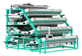
坐中台方还 公司是国内最早将可见光分选设备成功应用于矿石分选领域的企业,拥有多年的产品应用经验。随着环保 要求不断提高,各类矿石加工企业都在选择更加绿色环保的加工工艺。光电分选设备作为无污染的加工方法, 正在逐步替代转的加工设备。报告期内、公司针对各类鱼原、非金属等。进行简色、大小及异物分选,同时 针对不同等级,包括 30-100mm, 2-30mm, 2mm 以下颗粒及潮湿颗粒等提供解决方案。
