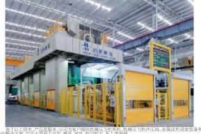
基于以上技术、产品及服务、公司为客户提供机械压力机单机、机械压力机冲压线、金属成形成套装备和个 解决方案、产品主要用于汽车、模具、家电、航空航天、霍工等领域。 ①机械压力机弹机,根据产品结构及应用领域的不同、公司提供不同类型的机械压力机,具体如下; 汽车领域,产品主要为闭式单点、双点、四点、多连杆等机型,用于汽车内板件和外覆盖件的拉伸冲压成形
