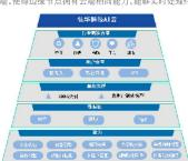
(4)数据安全管理系统 住华数据安全系统由国密认证的安全底座及不同垂直应用组成。自主研发高性能 PCIe 密码卡,并以此为基础研发高性能服务器密码机,实现高业务数据吞吐率、高在线并发服务数及业务动态扩展的功能;通过密销管理系统、时间截服务器、签名验签服务器等,建立从"终端到服务器侧"完备的国密安全产品体系。
