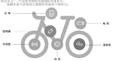
(注:上图只为了列示电踏车电气系统主要部件,实际安装位置因不同型号而异)
