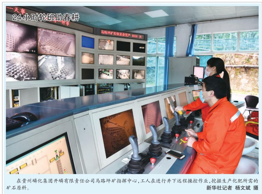
在贵州磷化集团开磷有限责任公司马场坪矿指挥中心,工人正在进行井下远程操控作业,挖掘生产化肥所需的矿石原料。
